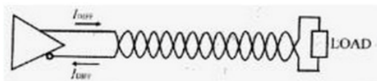
图 2: 无屏蔽双绞线中的差模信号
